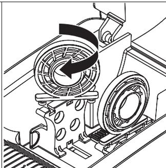
(2) Die Medienhalter lassen sich für Rollenkerndurchmesser von 1 Zoll oder 1,5 Zoll einsetzen – dazu drehen Sie das Oberteil der Medienhalter um 180° im Uhrzeigersinn.
