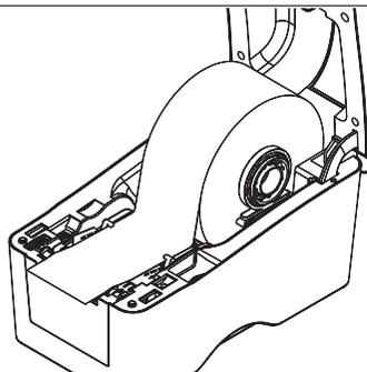
(4) Führen Sie das Papier mit der bedruckbaren Seite nach oben durch die Medienführungen und den Mediensensor, platzieren Sie die Vorderkante auf der Walze.
