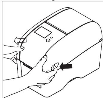
(1) Öffnen Sie die obere Druckerabdeckung, indem Sie die Hebel an beiden Seiten nach vorne ziehen. Anschließend heben Sie die Abdeckung bis zum Anschlag an.
