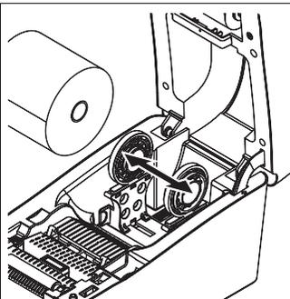
(3) Ziehen Sie die Medienhalter bis zur Breite der Etikettrolle auseinander. Legen Sie die Rolle zwischen die Halter, lassen Sie die beiden Lager in den Rollenkern greifen.
