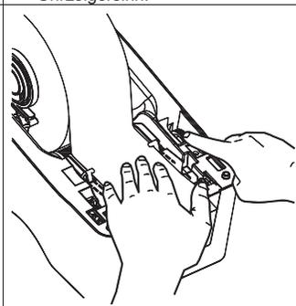
(5) Verschieben Sie die Medienführung durch Drehen des Führungseinstellknopfes passend zur Medienbreite.
