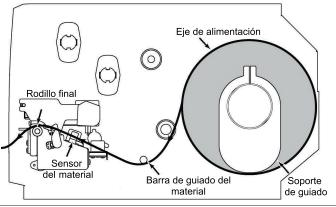
(7) Utilizando el panel de control frontal, establecer el tipo de sensor de material y calibrar el senser seleccionado. Nota: Recalibrar el sensor de los agujeros / marca negra cuando se cambie el material.
