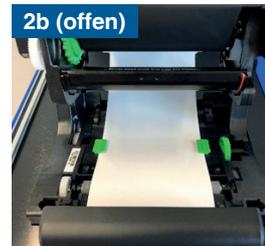
2. Drücken Sie zum Öffnen des Druckkopfmechanismus die Druckkopf-Freigabetaste.
