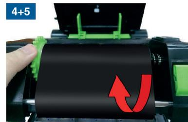
4. Ziehen Sie den Vorlauf des Farbbandes durch den Druckkopf, befestigen Sie den Vorlauf des Farbbandes mit einem Stückchen Klebeband an der Aufwickelwalze.
