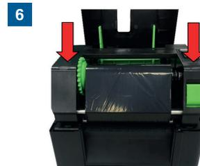
5. Schließen Sie den Druckkopfmechanismus mit beiden Händen; achten Sie darauf, dass die Riegel richtig greifen.
