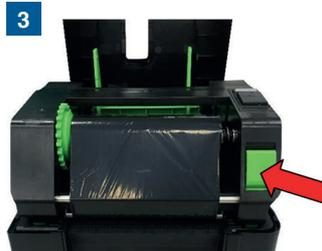
Hinweis: Die Position des Schwarzmarkensensors ist beweglich und der Lückensensor ist fixiert. Bitte achten Sie darauf, dass sich die Lücke bzw. schwarze Markierung an der Position befindet, welche die Medienlücke/-schwarzkennzeichnung zur Erkennung durchläuft.
