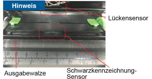
4. Führen Sie das Medium mit der bedruckbaren Seite nach oben durch den Mediensensor, platzieren Sie die Vorderkante auf der Walze. Verschieben Sie die Medienführungen passend zur Etikettenbreite.
