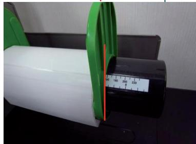
4. Setzen Sie die Medienrolle auf die Etikettenversorgungsspindel. Bringen Sie den Etikettenrollenschutz wieder an. Achten Sie darauf, dass die Positionen des Etikettenrollenschutzes an beiden Seiten der Länge des Etiketts entsprechen. Bitte stellen Sie sicher, dass beide Außenkantenskalen zumindest annähernd der Etikettenbreite entsprechen.
