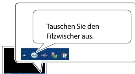
Der Filzwischer kommt bei der Reinigung der Druckköpfe zum Einsatz. Wenn die gezeigte Meldung neben dem "Utility"-Symbol erscheint, muss der Wischer ausgetauscht werden.
