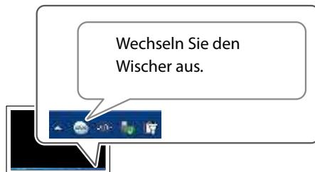
Der Wischer kommt bei der Reinigung der Druckköpfe zum Einsatz. Wenn die gezeigte Meldung neben dem "Utility"-Symbol erscheint, muss der Wischer ausgewechselt werden.
