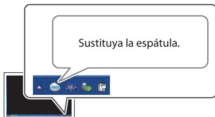
La espátula es un componente que se utiliza para limpiar los cabezales de impresión. Cuando el mensaje de la figura aparece en el ícono de Utilidad de la bandeja de tareas del ordenador, debe sustituir la espátula por una de nueva.
