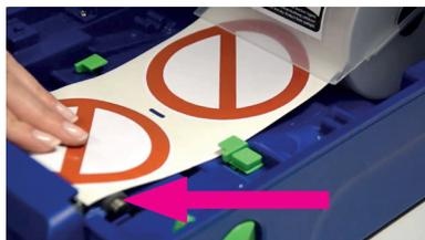
4. Anschließend das Folienband mit Hilfe der Medienführung fixieren.
