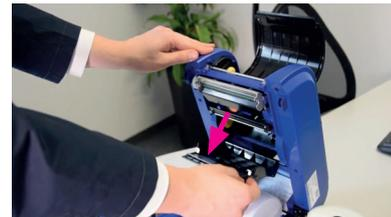
2. Farbbandkern für verbrauchtes Material oben einlegen, indem er erst auf der rechten Seite eingehakt wird und dann links in dem oberen Aufnahmeteller fixiert wird.
