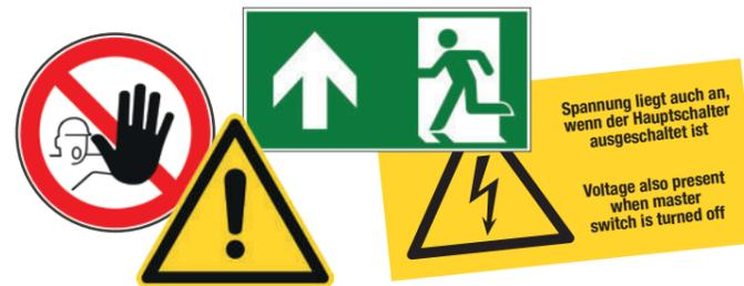
Spannung liegt auch an, wenn der Hauptschalter ausgeschaltet ist
