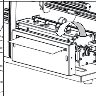
(4) Ziehen Sie die Etikettenrollen-Vorderkante nach vorne durch die Medienführungsschiene vorbei am Mediensensor; platzieren Sie die Vorderkante auf der Druckwalze.
