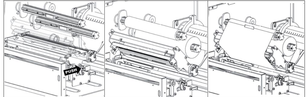
(1) Öffnen Sie die Abdeckung des Druckers. Öffnen Sie den Druckkopfmechanismus durch Drücken des Druckkopf-Freigabehebels.
