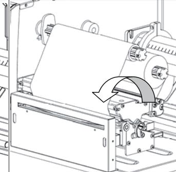
(5) Schließen Sie den Druckkopfmechanismus; achten Sie darauf, dass die Riegel richtig greifen.
