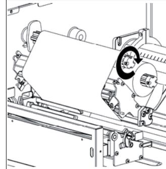
(4) Drehen Sie die Farband-Aufwickelspindel kraftvoll 3- bis 5-mal im Uhrzeigersinn, bis das Farbband glatt gezogen, richtig gespannt und faltenfrei ist.
