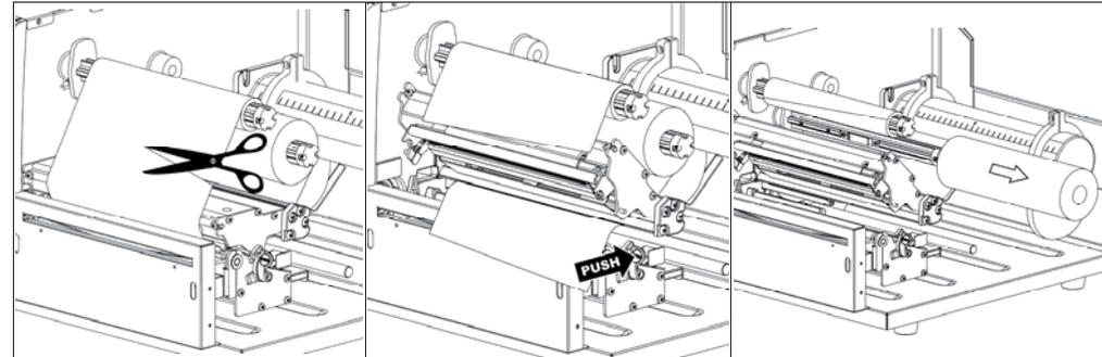
(1) Trennen Sie das Farbband zwischen der Farbandführungsschiene und der Farband-Aufwickelspindel.
