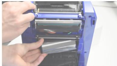
4. Transparenten Teil des Farbbandes am Klebestreifen lösen und herausziehen. Das Band über den Druckkopf führen und oben auf die obere Aufnahmerolle kleben.
