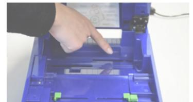
3. „LabelMax SP3 Siegel“ entfernen, Folienband herausziehen und auf der Transportwalze ablegen.
