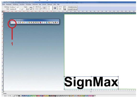
Durch klicken auf die oben markierten Werkzeuge können Sie das Objekt drehen, so dass die Folie optimal genutzt wird. Anschließend klicken Sie auf die Schere in der Schneidewerkzeugbox, der Schneideauftrag wird gestartet.
