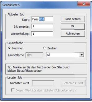
Der Befehl "Serialisierung und Etikettenerstellung" aus dem Menü "Gestaltung" wird zum Serialisieren von Textdaten benutzt.
