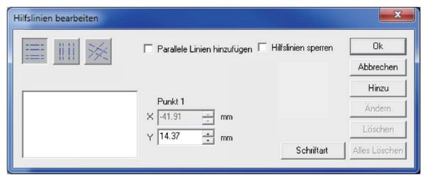
Klicken Sie mit der rechten Maustaste auf die Arbeitsfläche, um das Dialogfeld "Hilfslinien bearbeiten" zu öffnen. Legen Sie die Ausrichtung der Linie mit vertikal fest. Legen Sie die Koordinaten für Punkt 1 fest.
