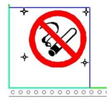
Die Passermarken werden bei jeder Farbe mit geplottet, so dass Sie sich beim Aufkleben der einzelnen Folien danach richten können.
