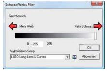
In diesem Fenster muss der Weißfilter eingestellt werden. Dieser Weißfilter bestimmt, welche Teile des Bildes (der weiße Hintergrund) von der Schneidelinie außer Acht gelassen werden. Das Ergebnis können Sie schon während des Einstellens beurteilen, da die Kontur-Cut-Linie, die erstellt wird, angezeigt wird. Die Kontur-Cut-Linie sollte nun ein exaktes Abbild des Motives sein.
