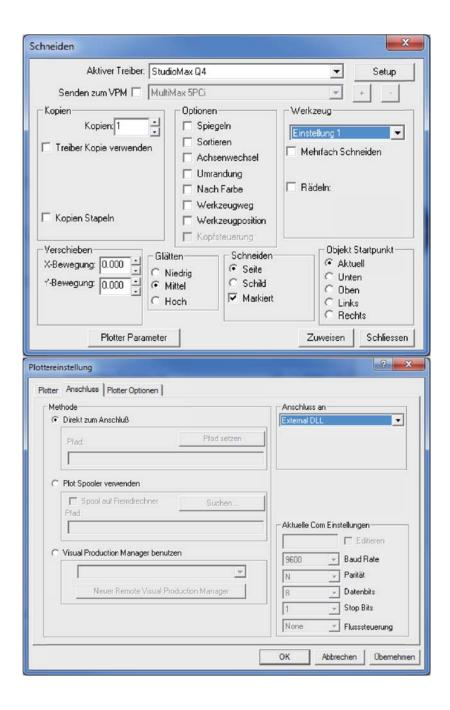
Wichtig ist hier der Reiter Anschluss. Bei "Anschluss an" müssen Sie den richtigen Anschluss Ihres Plotters wählen, z.B. LPT1 für Parallel oder COM2 für Seriell. Für USB-Anschluss muss "External DLL" ausgewählt sein.
